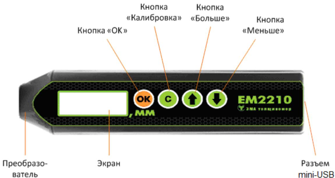
Прибор выполнен в пластиковом корпусе, в передней части которого находится съёмный преобразователь.
